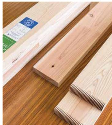
木材はもともと水分を多く含んでいるため、乾燥が不十分だと狂い、割れ、反りが生じてしまいます。そのため集成材はひき板(ラミナ)の段階で天然乾燥に加え、乾燥装置を用いて、含水率を15%以下まで乾燥して、狂い、割れ、反りの防止を図っています。
